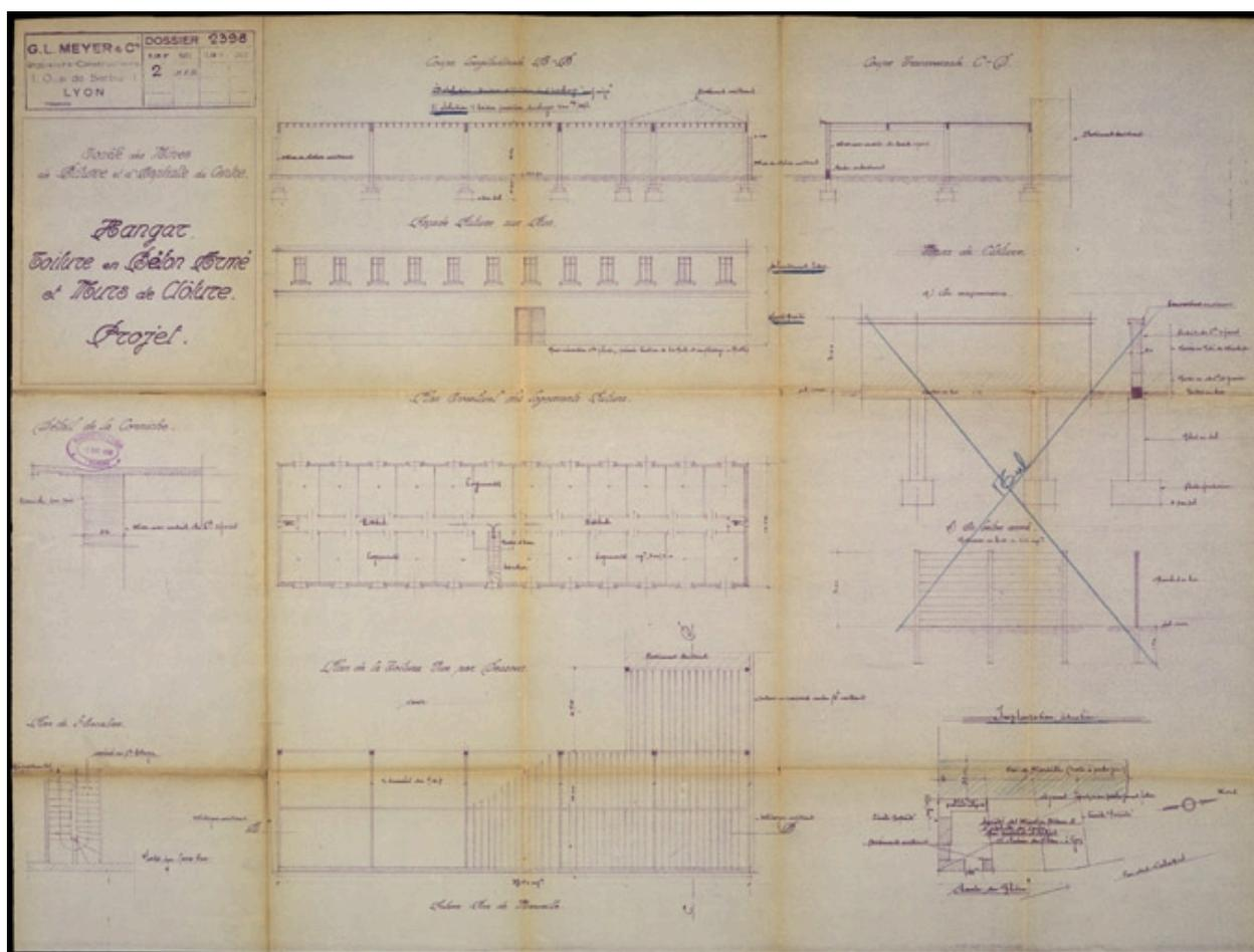
Hangar toiture en béton armé : coupe longitudinale, plan de la toiture, plan éventuel de logements futurs
