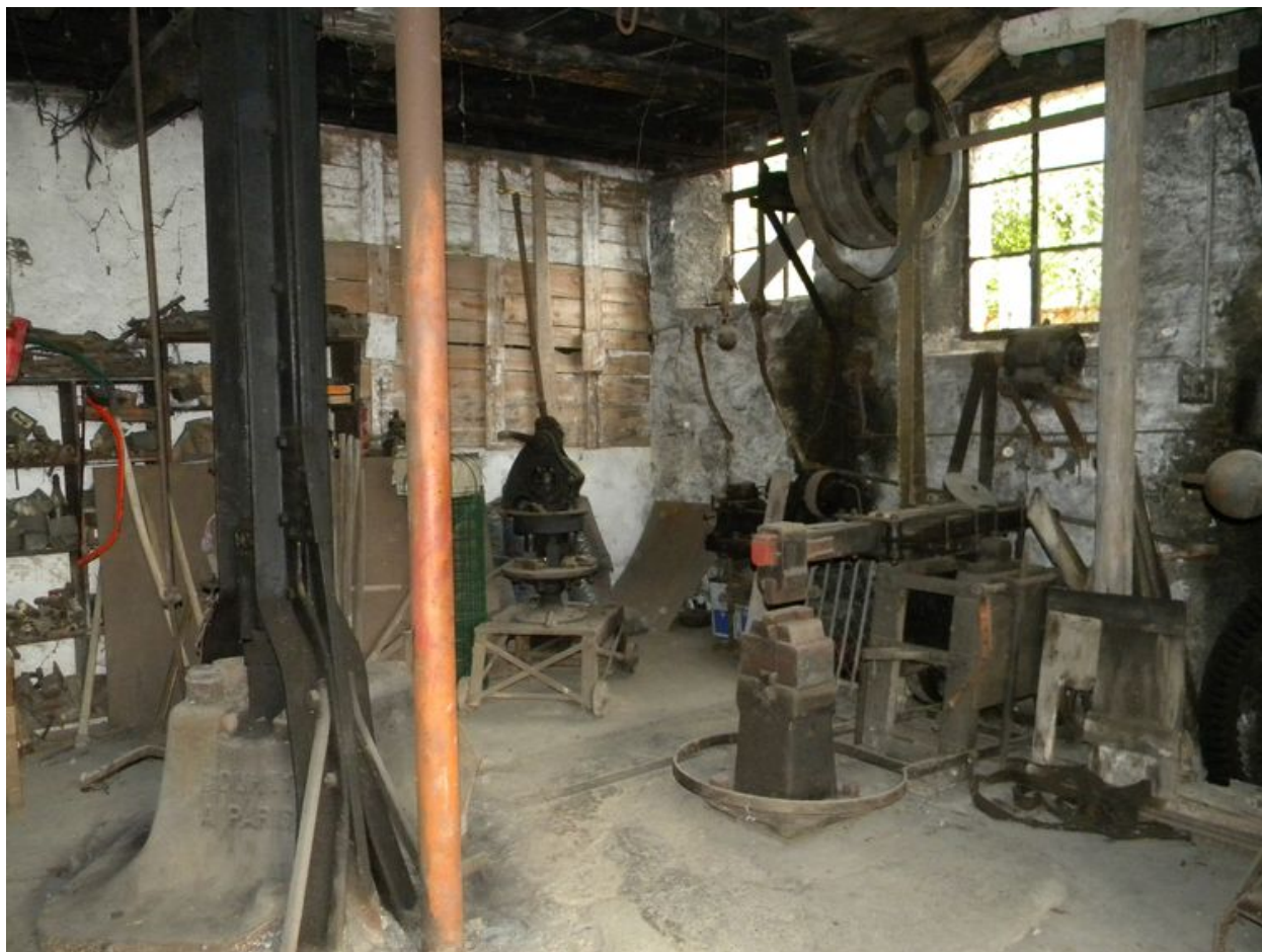
Vue de l'atelier : martinet hydraulique et presse manuelle.
