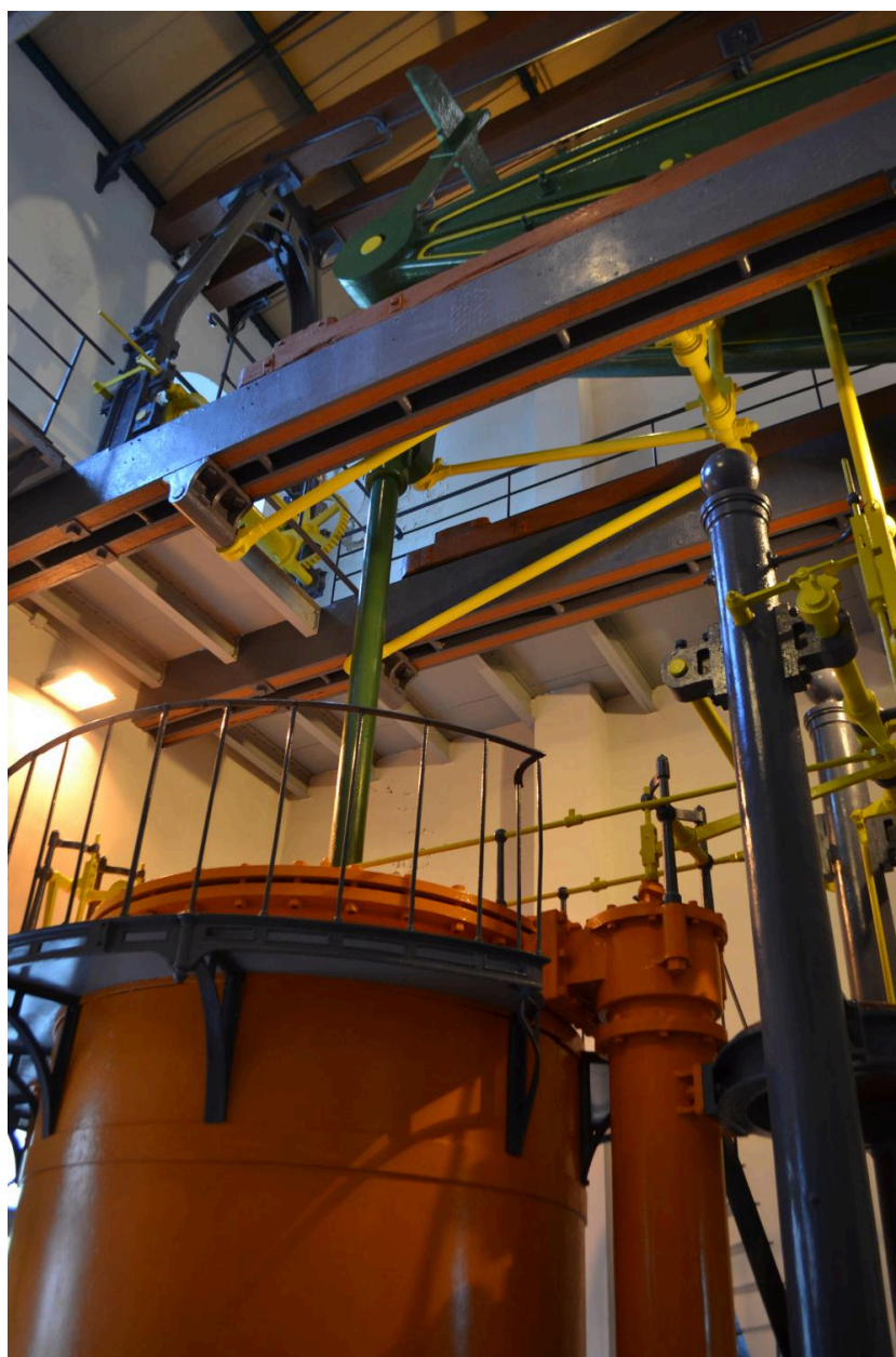
Partie supérieure de la pompe : détail balancier
