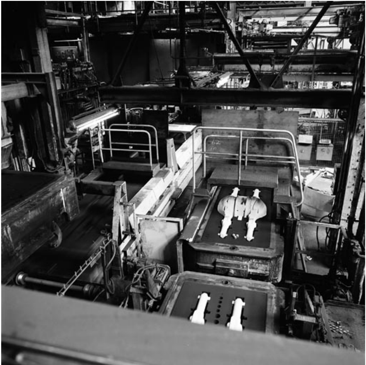
Fonderie : ligne 17, moulage, moule inférieur avec noyau déposé.
