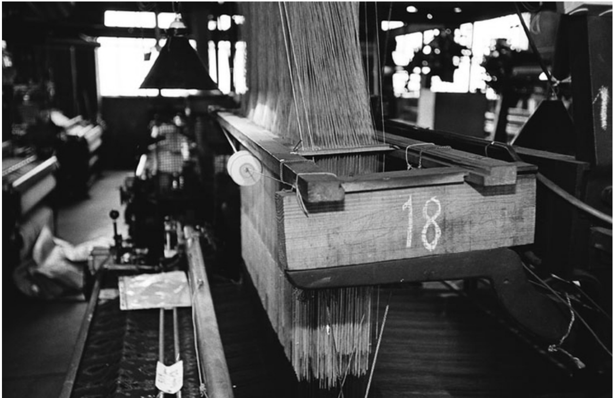
Détail fils de trame du métier n° 18
