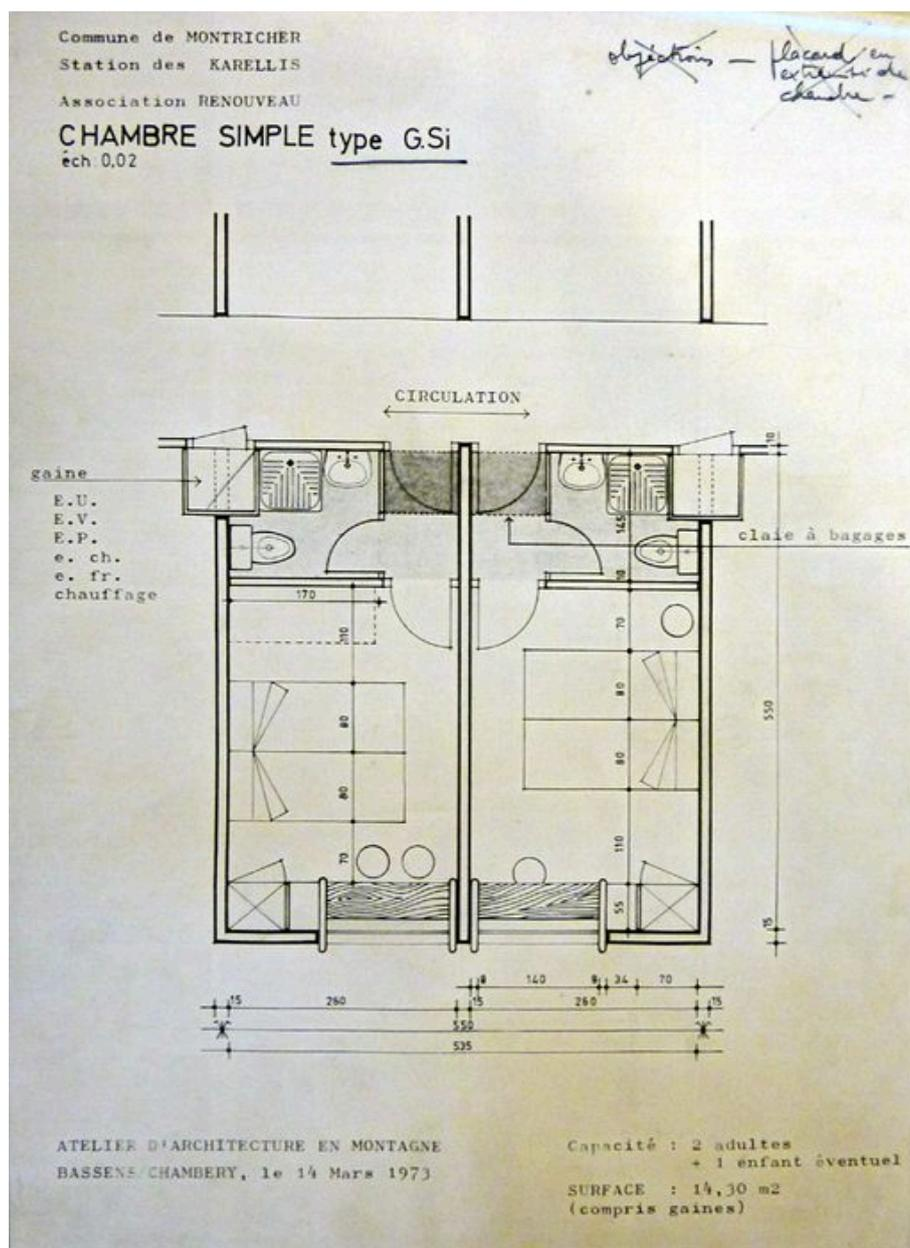
Chambre simple type G.Si.. Plan. Atelier d'architecture en Montagne, 14 mars 1973 (AD Savoie. 6J 1450 )
