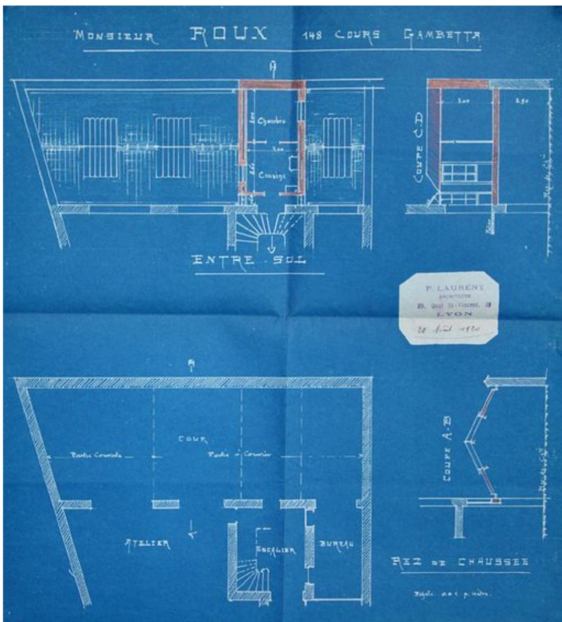
Plan joint à la demande de permis de construire en vue de la couverture de la cour et de la modification de la loge de concierge, 1920
