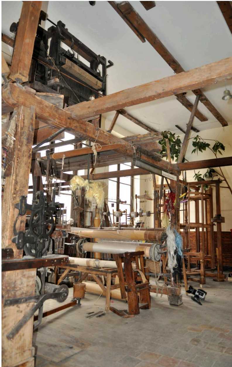
Ourdissoir de 1830 en noyer et métier pour nouveauté (90cm) de l'atelier de tissage à bras de Georges Mattelon
