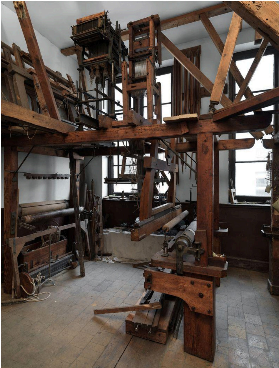
Détail métier à tisser à bras et partie haute mécanique
