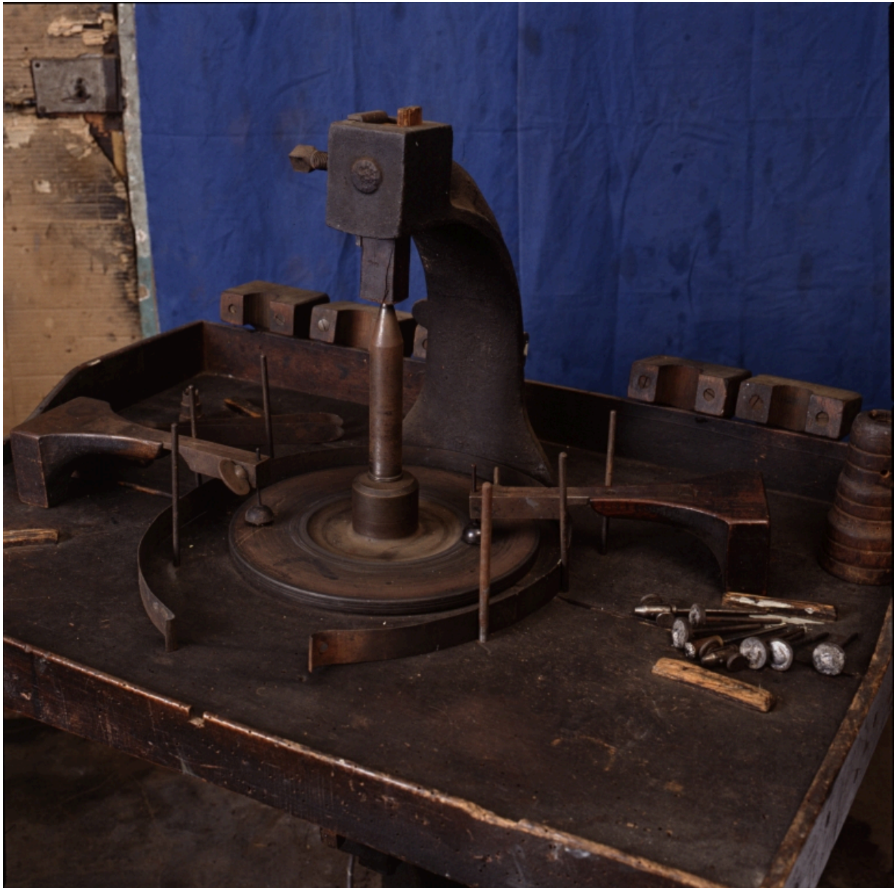
Lapidaire (tour à aplatir), vue de dessus.
