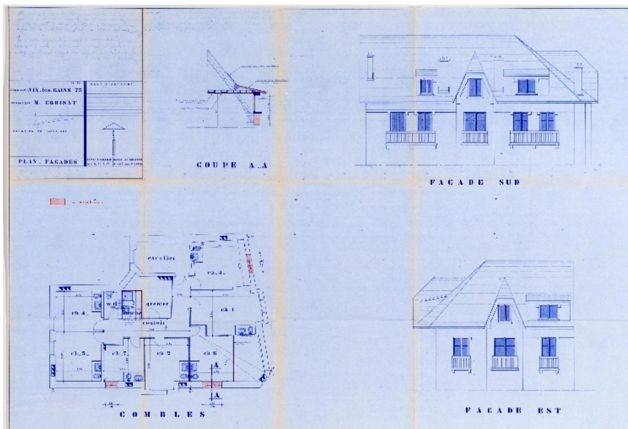
Plan, coupe et élévation de l'aménagement des combles
