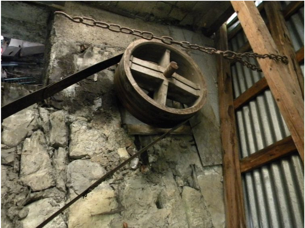
Vue d'une poulie et d'une courroie de transmission débrayable.
