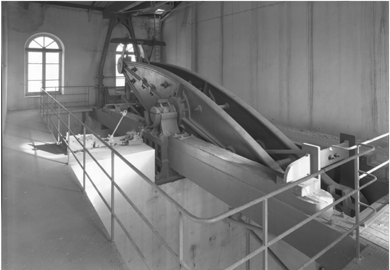
Pompe de Cornouailles : vue d'ensemble du balancier
