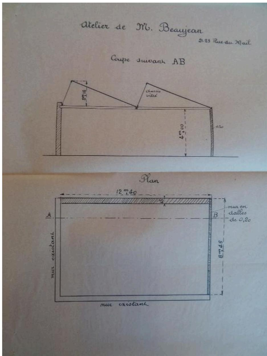
Plan et coupe de l'atelier de tissage sur cour réaménagé en logement (Arch. Mun. Lyon, 344 W413 : Constructions neuves, 1923)
