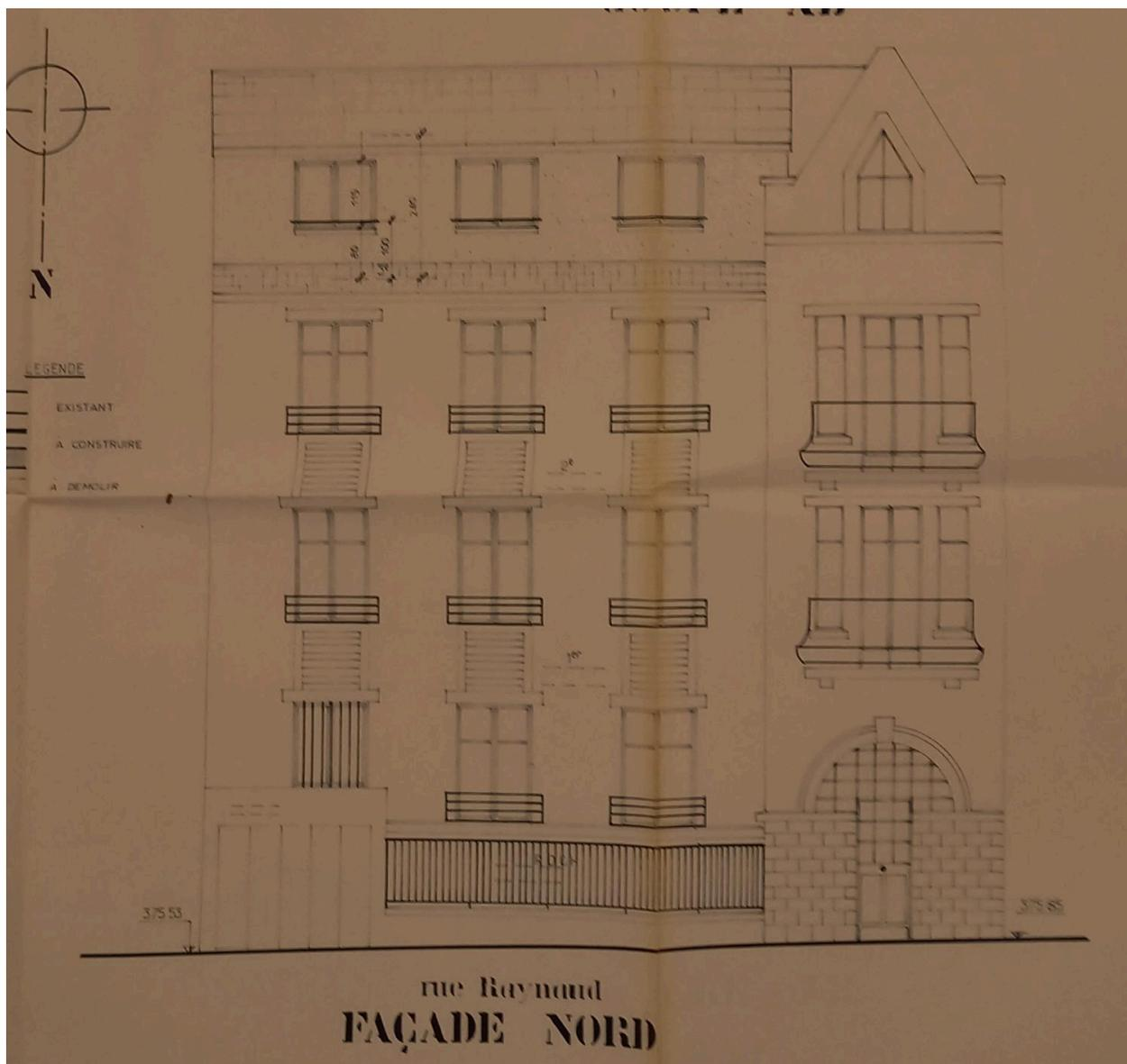
Élévation sur la rue du 18 rue Raynaud, projet non exécuté de surélévation d'un étage
