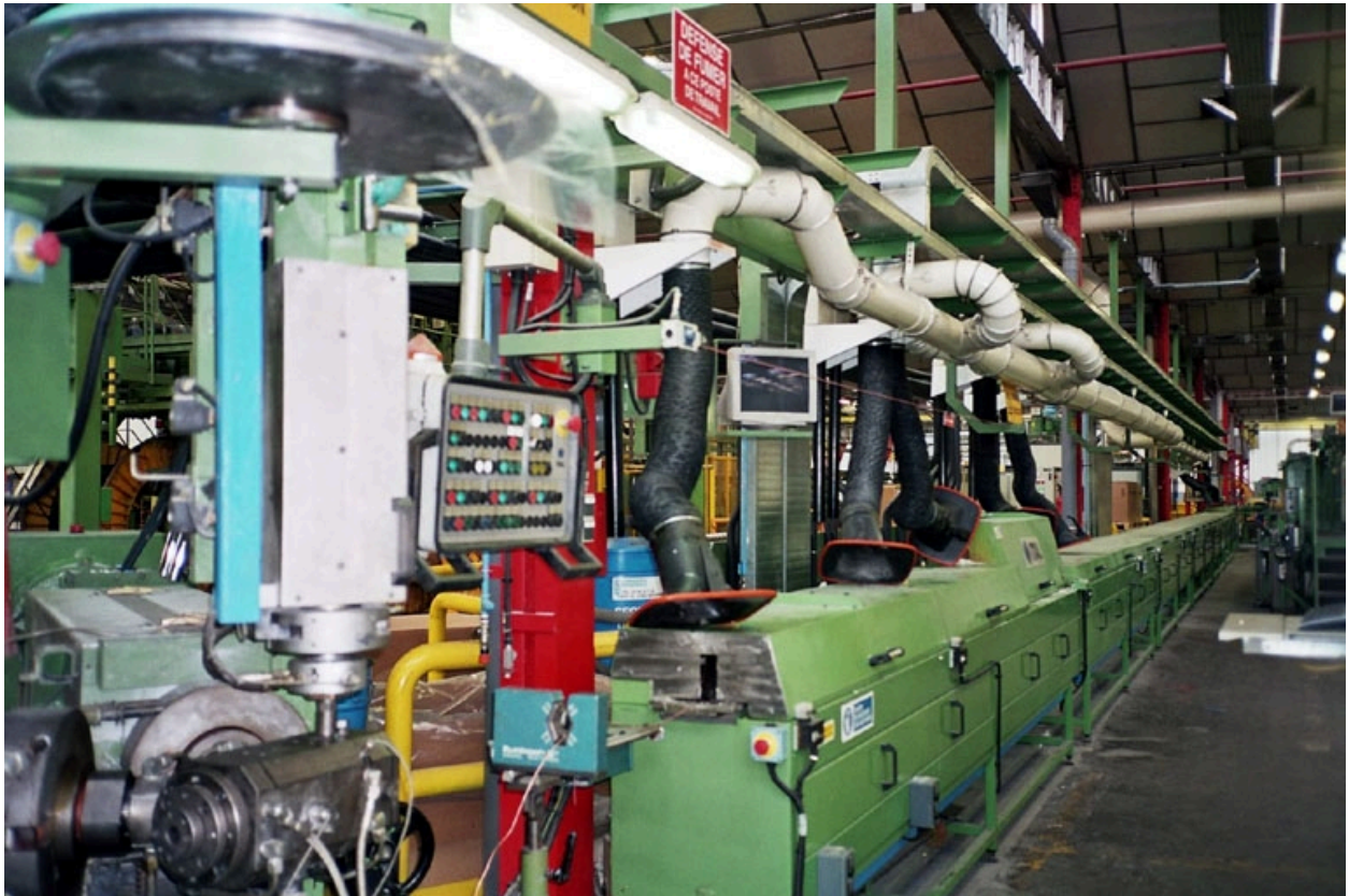
Ligne E08, bains de sel métallique
