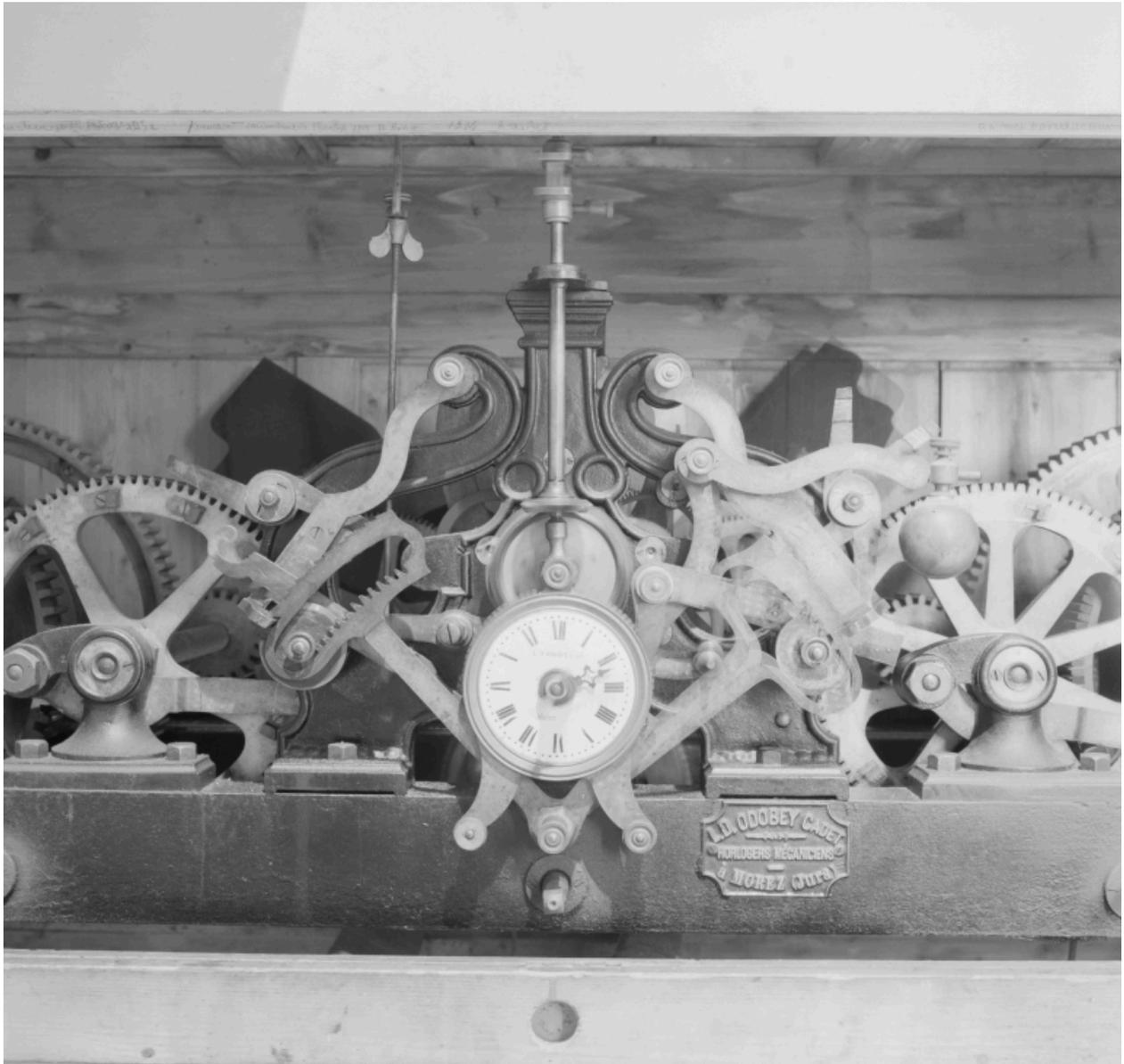
Mécanisme d'horlogerie de la sonnerie électrique de la cloche, vue de face.
