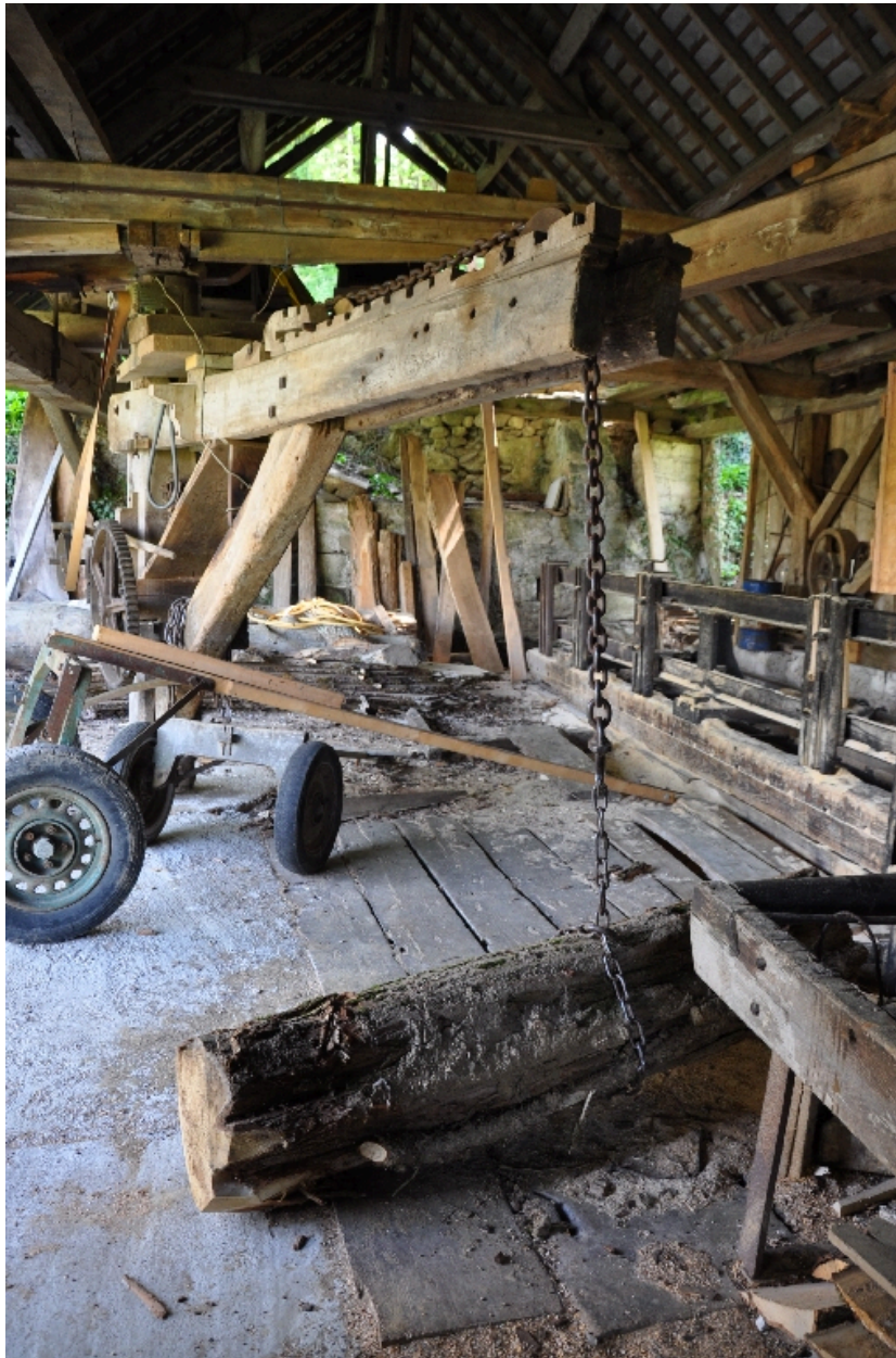
Détail du treuil avec une bille de bois prête à la découpe
