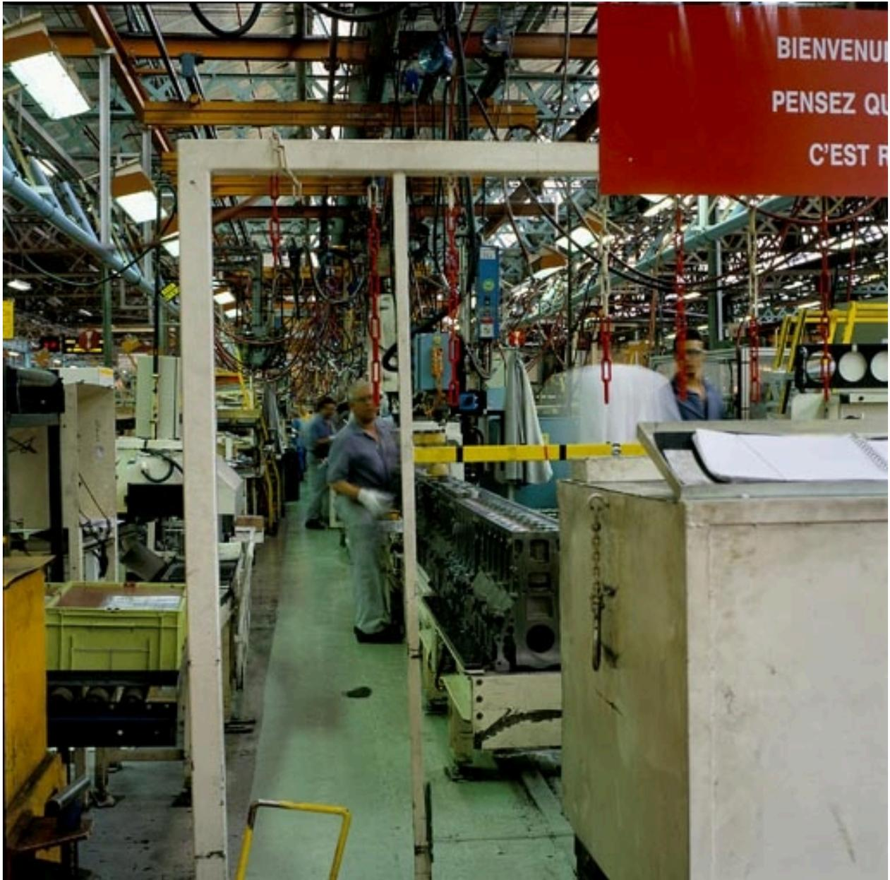
Ligne montage moteur : départ montage moteurs autobus autocars 11 litres et 10 litres.
