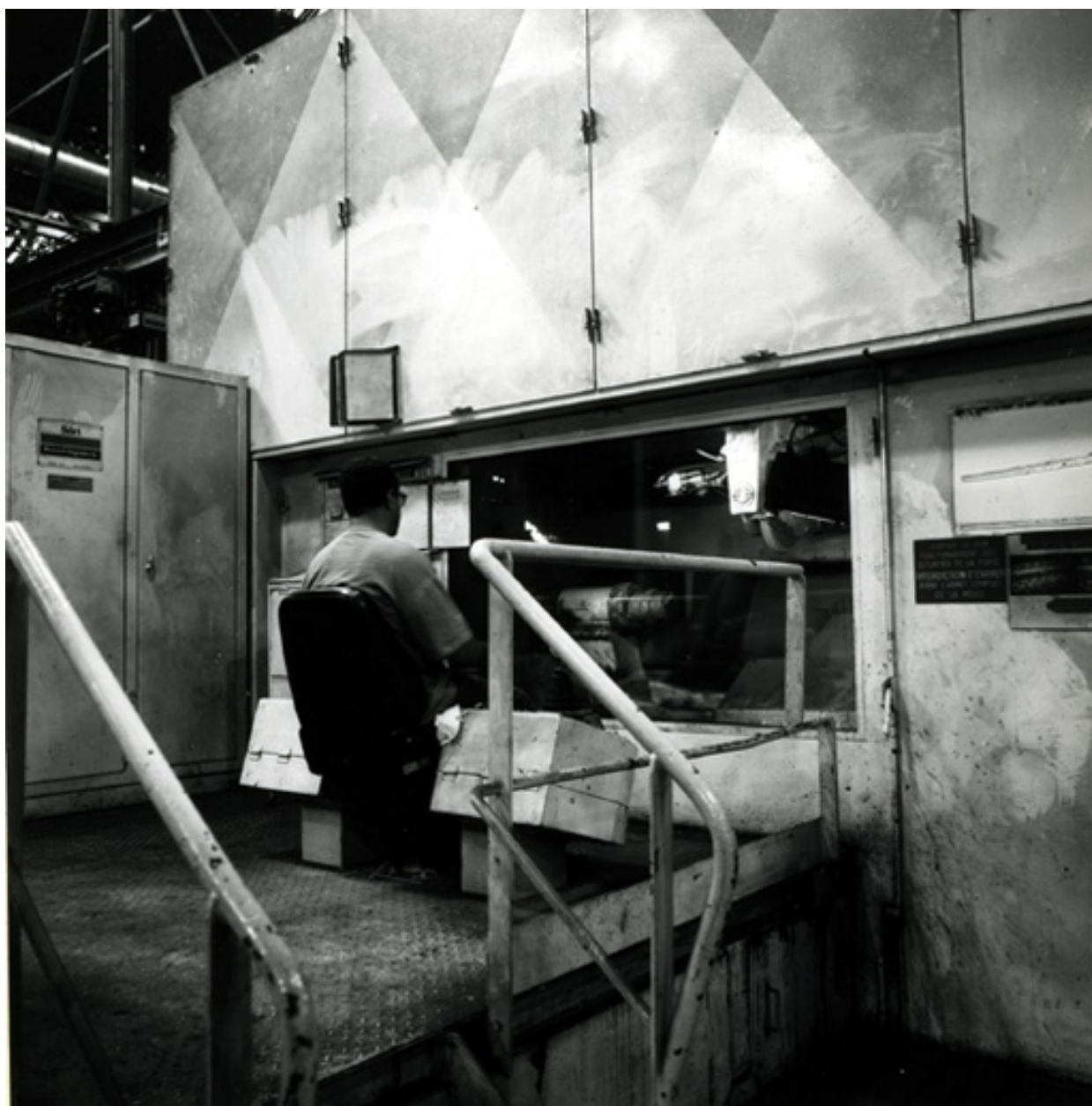
Fonderie : parachèvement sud, machine à meuler semi-automatique de marque Séri.
