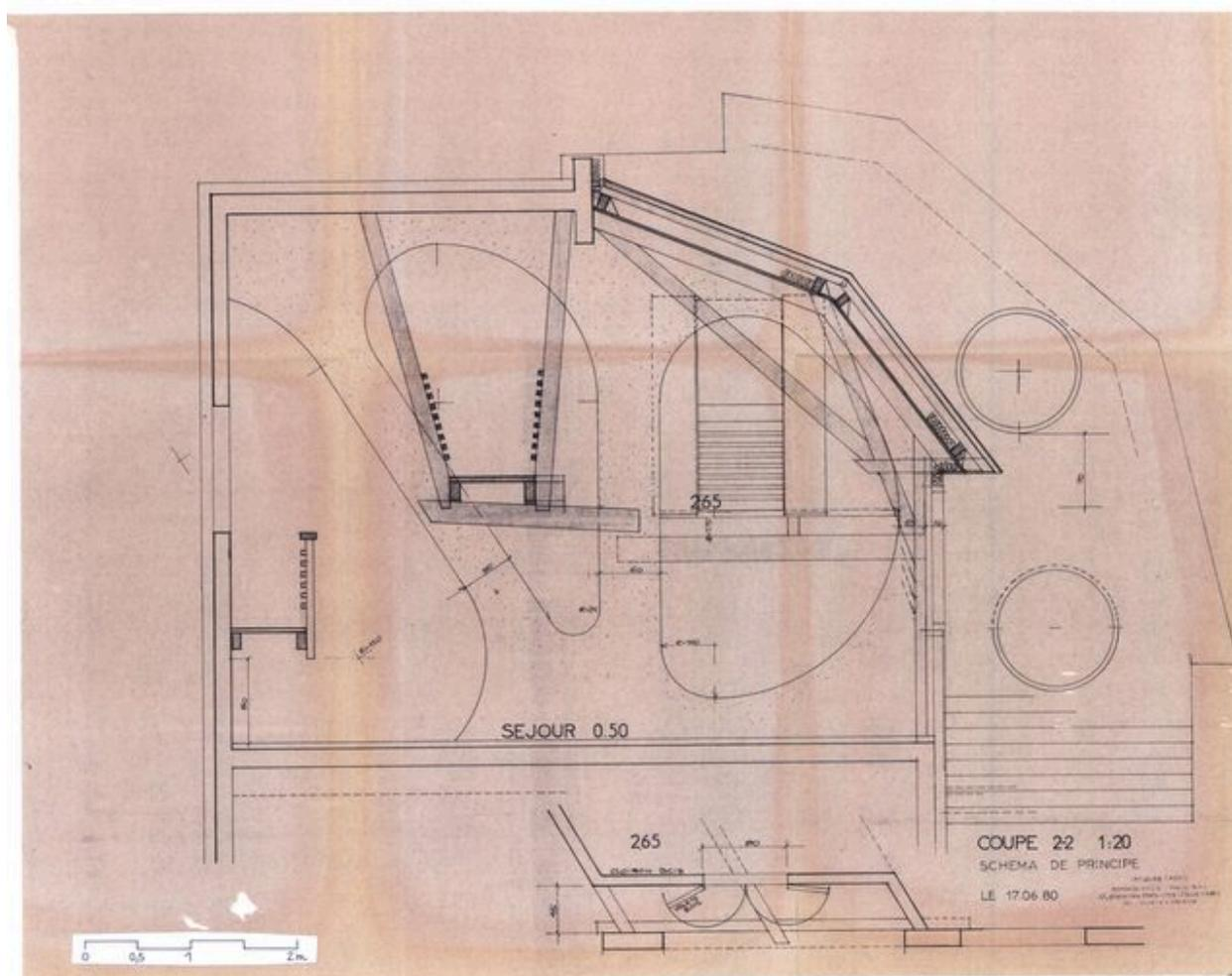
Détails d'exécution. Juin 1980. Coupe 2-2. Schéma de principe / J. Labro (A. privées J. Labro)
