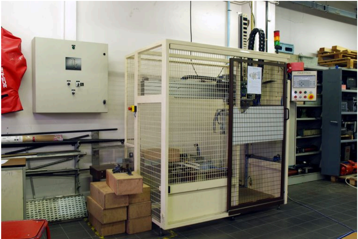
Machine à organiser des cartons sur une palette
