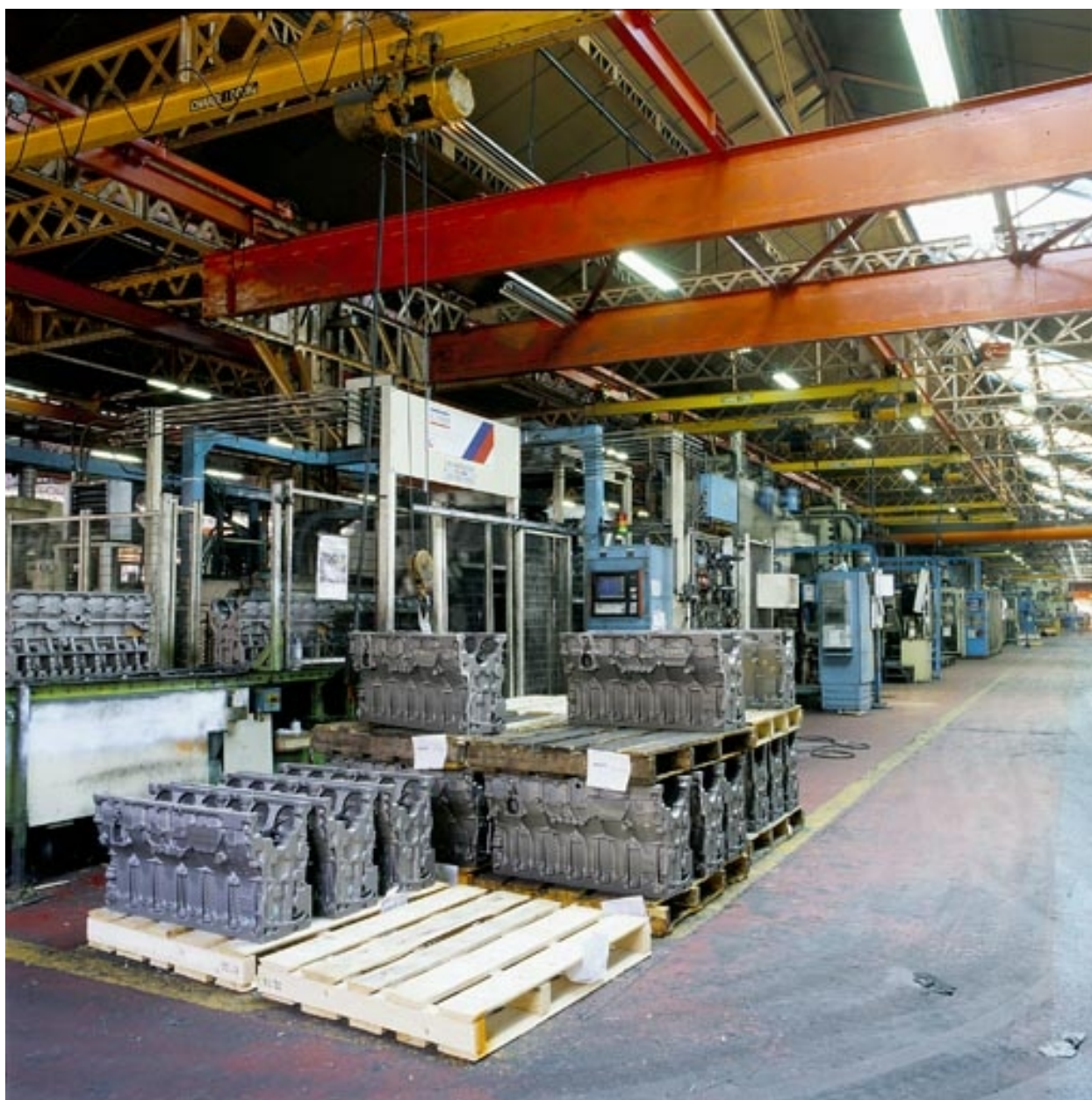
Usine moteur : ligne Ingersol (moteur 11 litres)
