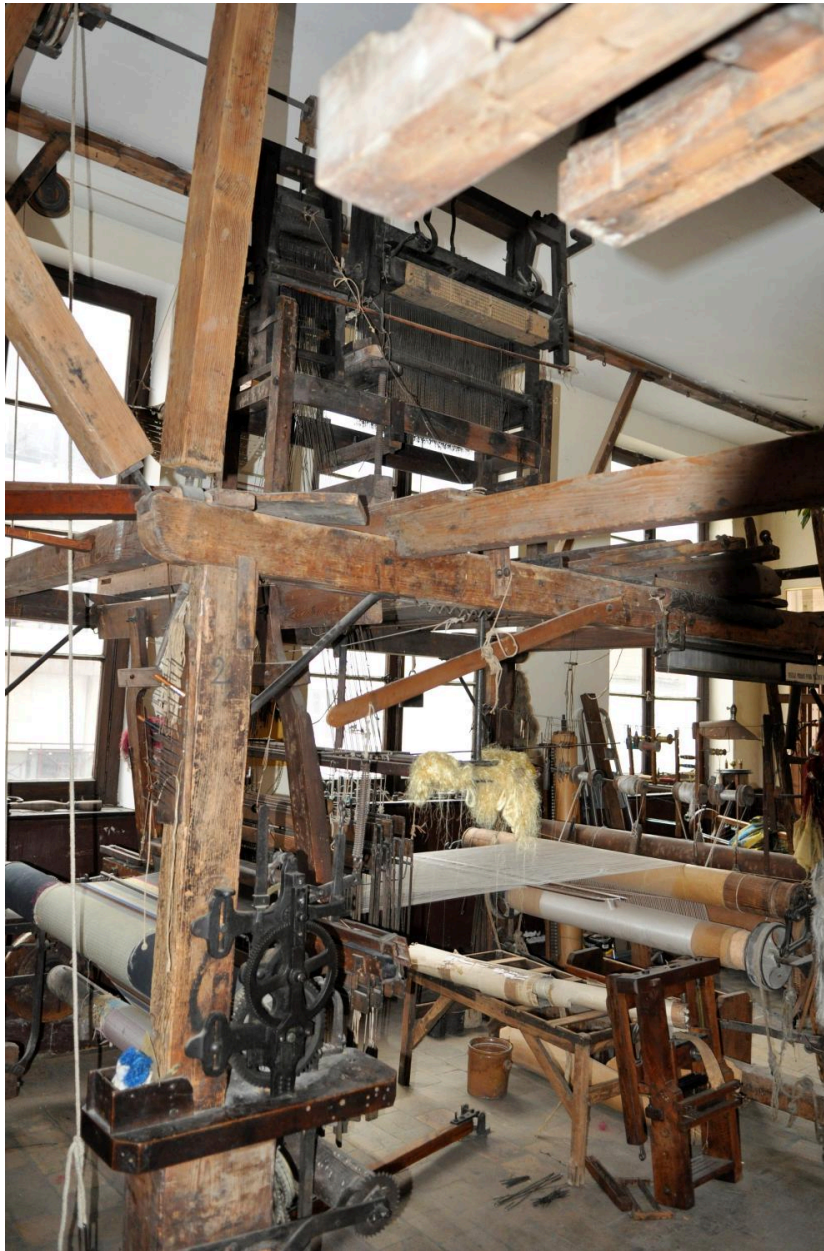
Grand métier à tisser, métier grande largeur (140cm) Taffetas, Caméléon de l'atelier de tissage à bras de Georges Mattelon en 2016
