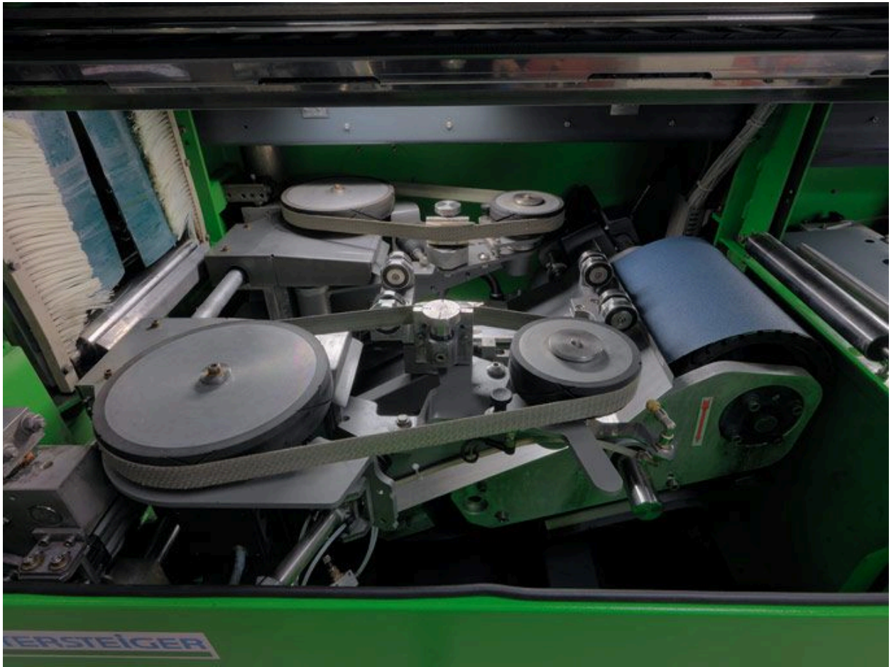
Le magasin de location de skis. Atelier de réparation. Machine Discovery pour le ponçage, le meulage et le fartage
