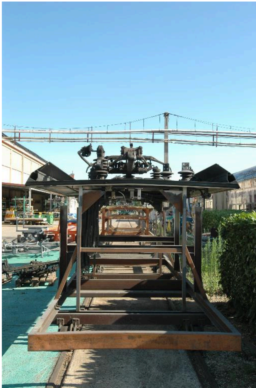
Elément de toit d'une machine électrique avec le pantographe.
