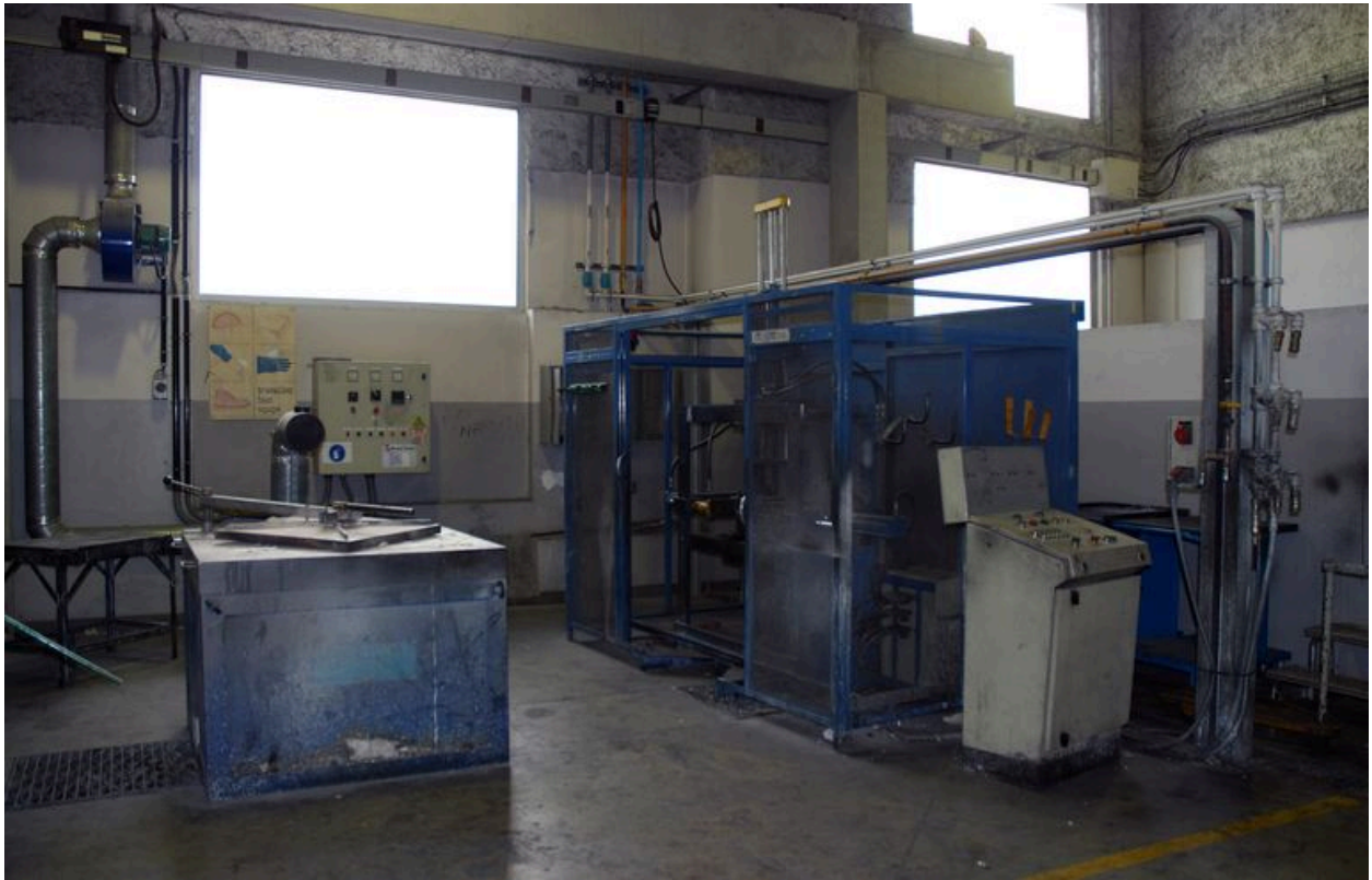
Four à aluminium MORGAN THERMIC et coquilleuse automatisée
