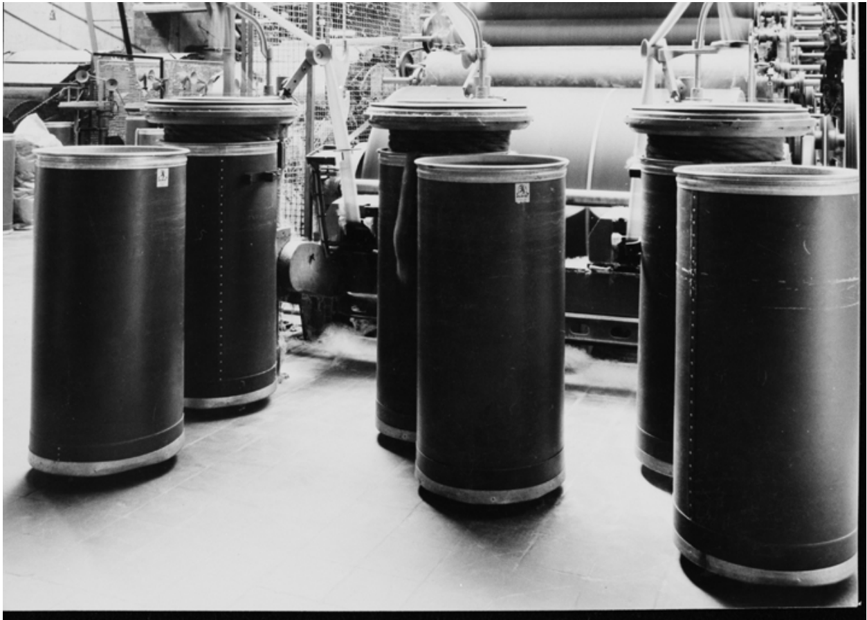
Sortie de la matière 1ère en ruban de la carte pour intersecting (vers 1960)
