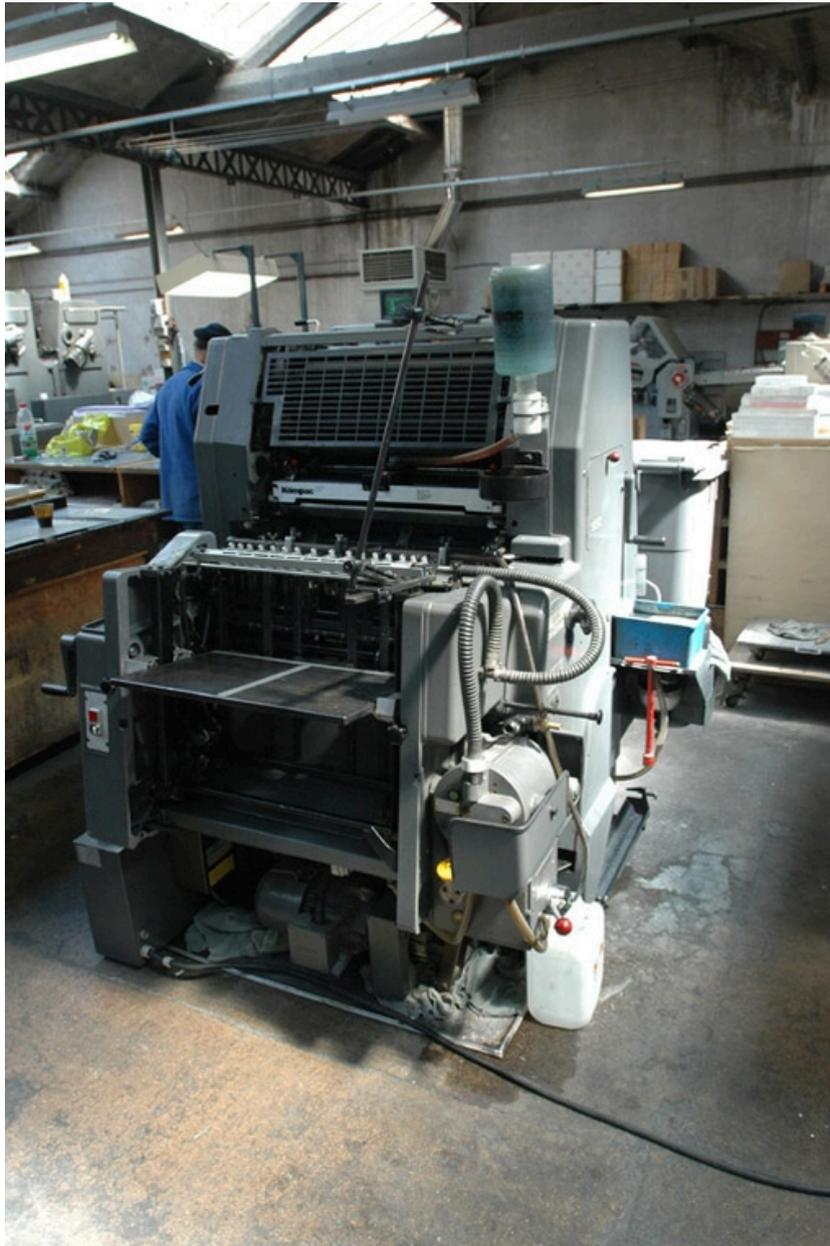
Machine offset monochrome, vue avant, (cf n°4 sur le plan).
