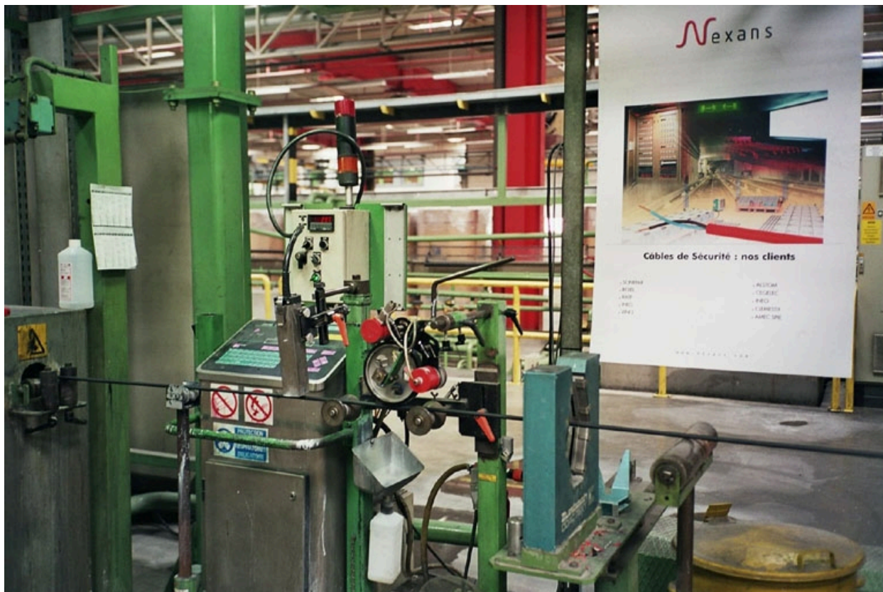
Machine à marquer le câble : marquage jet d'encre
