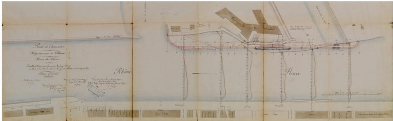
Plan général d'exhaussement de la digue de la Vitriolerie et de l'achèvement de l'endiguement insubmersible sur la rive gauche du Rhône en aval du pont Napoléon. 1865
