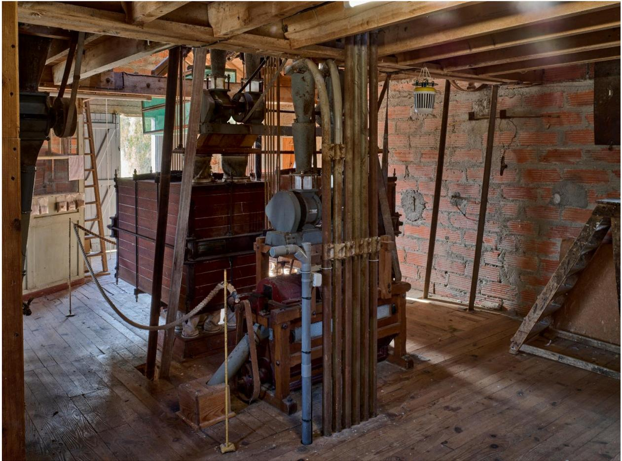
Vue du 2e étage : extracteur Cusson au premier plan, plansichter au second plan, porte double percée dans la façade en mur-pignon au nord en troisième plan.
