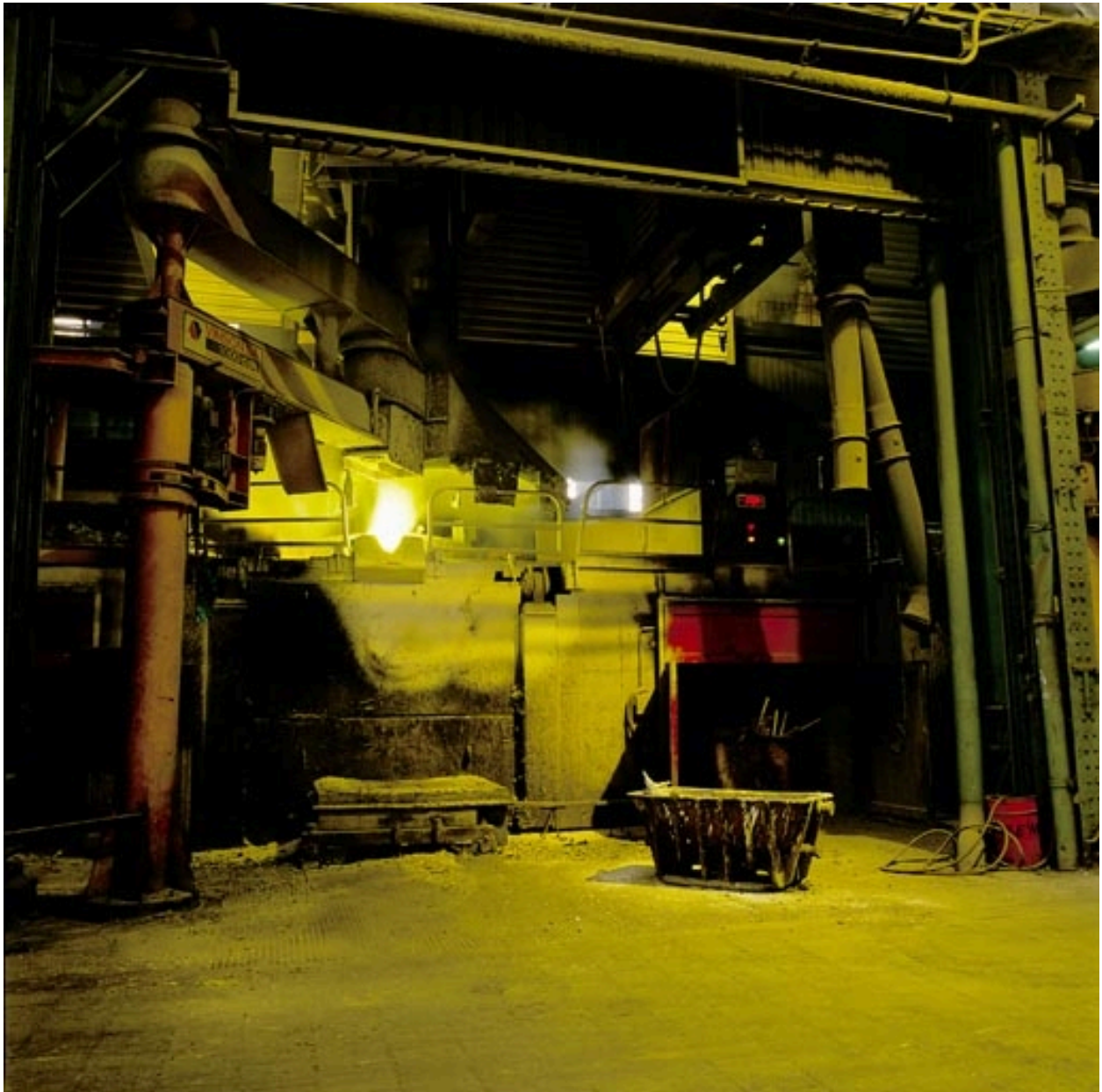
Fonderie : four à induction.
