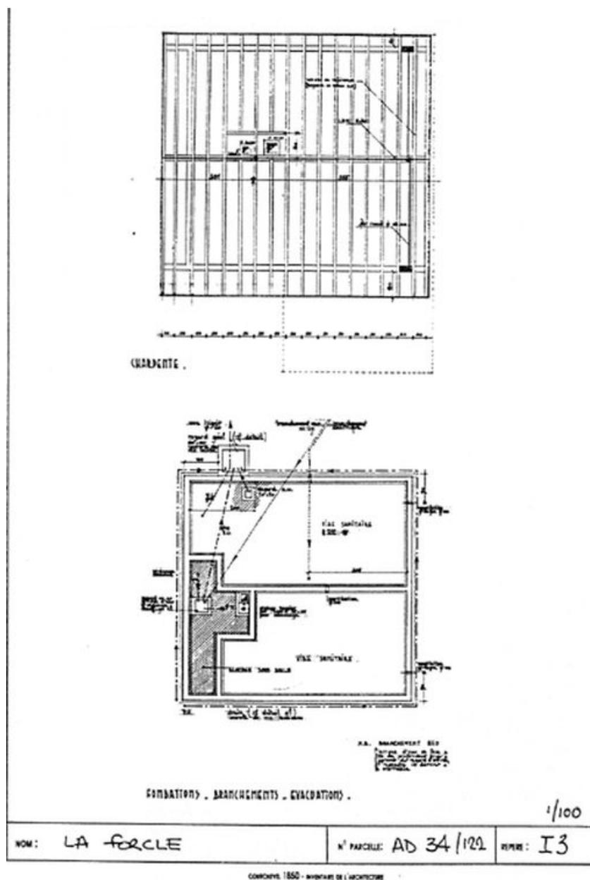
Plan des fondation ; plan de la charpente
