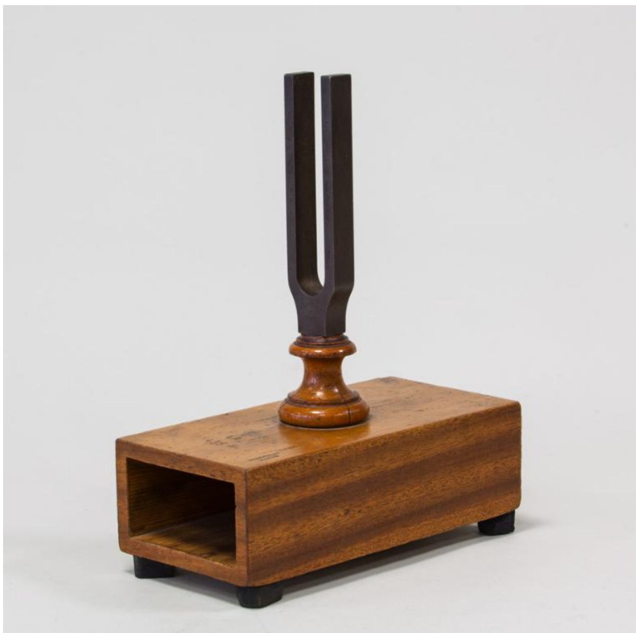
Sciences physiques : diapason sur caisse de résonance
