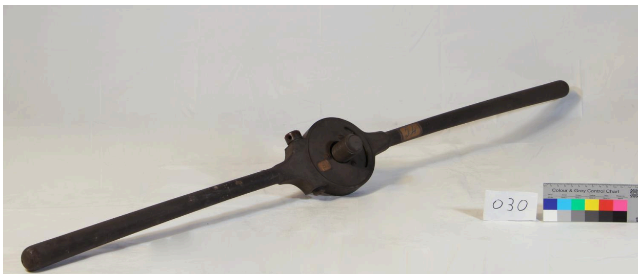
Clé de taraud, vue de côté (objet 030)
