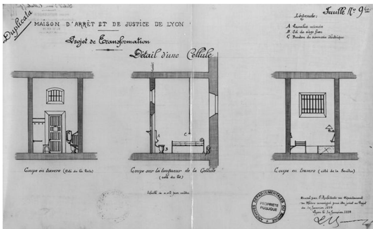
Transformation de la maison d'arrêt et de justice de Lyon en prison cellulaire : détail d'une cellule (coupe en travers côté porte, coupe sur la longueur, coupe en travers côté fenêtre), H. Moncorger, 1885. calque entoilé, 10 janvier 1885, 26,5 x 43,5 AD,
