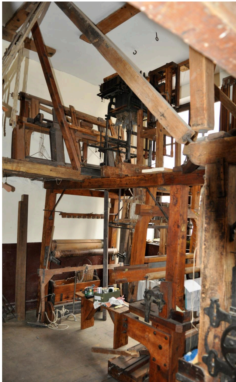
Métier pour nouveauté petite largeur (54 cm x 70cm) en montage : Atelier de tissage à bras de Georges Mattelon en 2016
