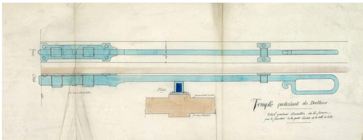
Dessin technique d'exécution de la ferrure pour la fermeture de la porte de la salle de culte.
