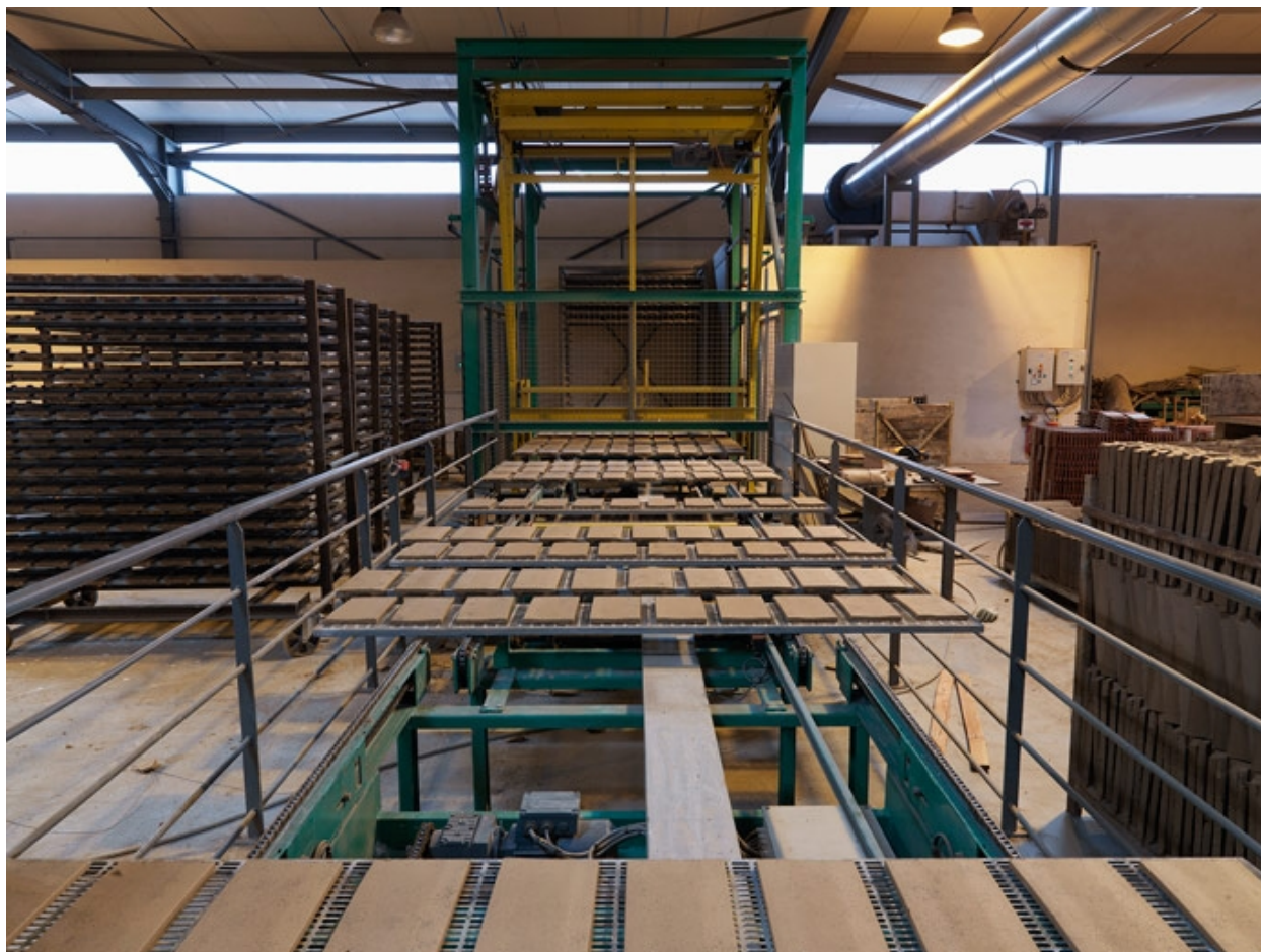
Chaîne de fabrication des tuiles
