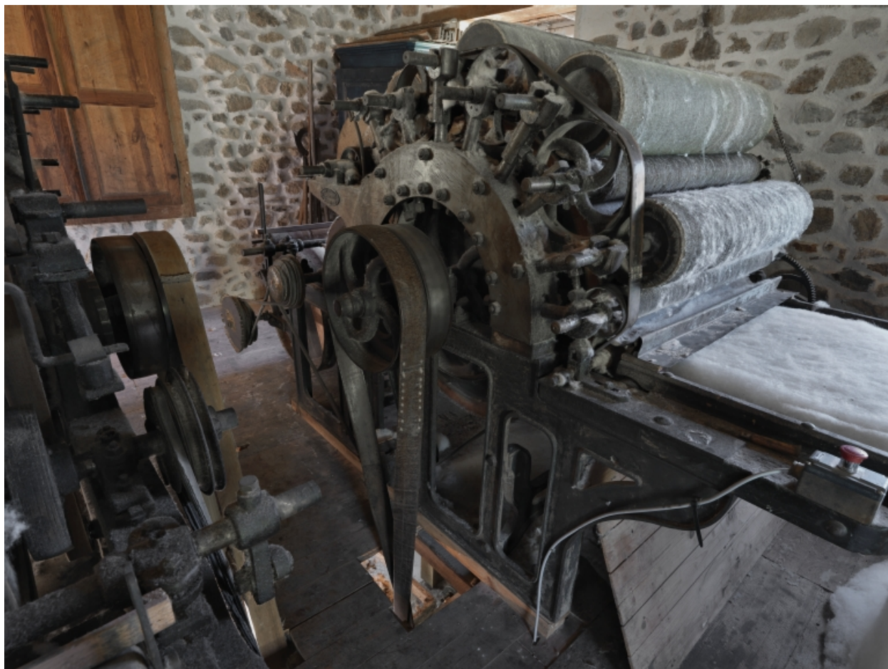
Détail rouleaux et passage courroie de transmission
