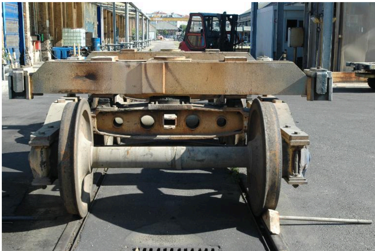
Faux boogie servant à déplacer les moteurs dans l'atelier, vue arrière.
