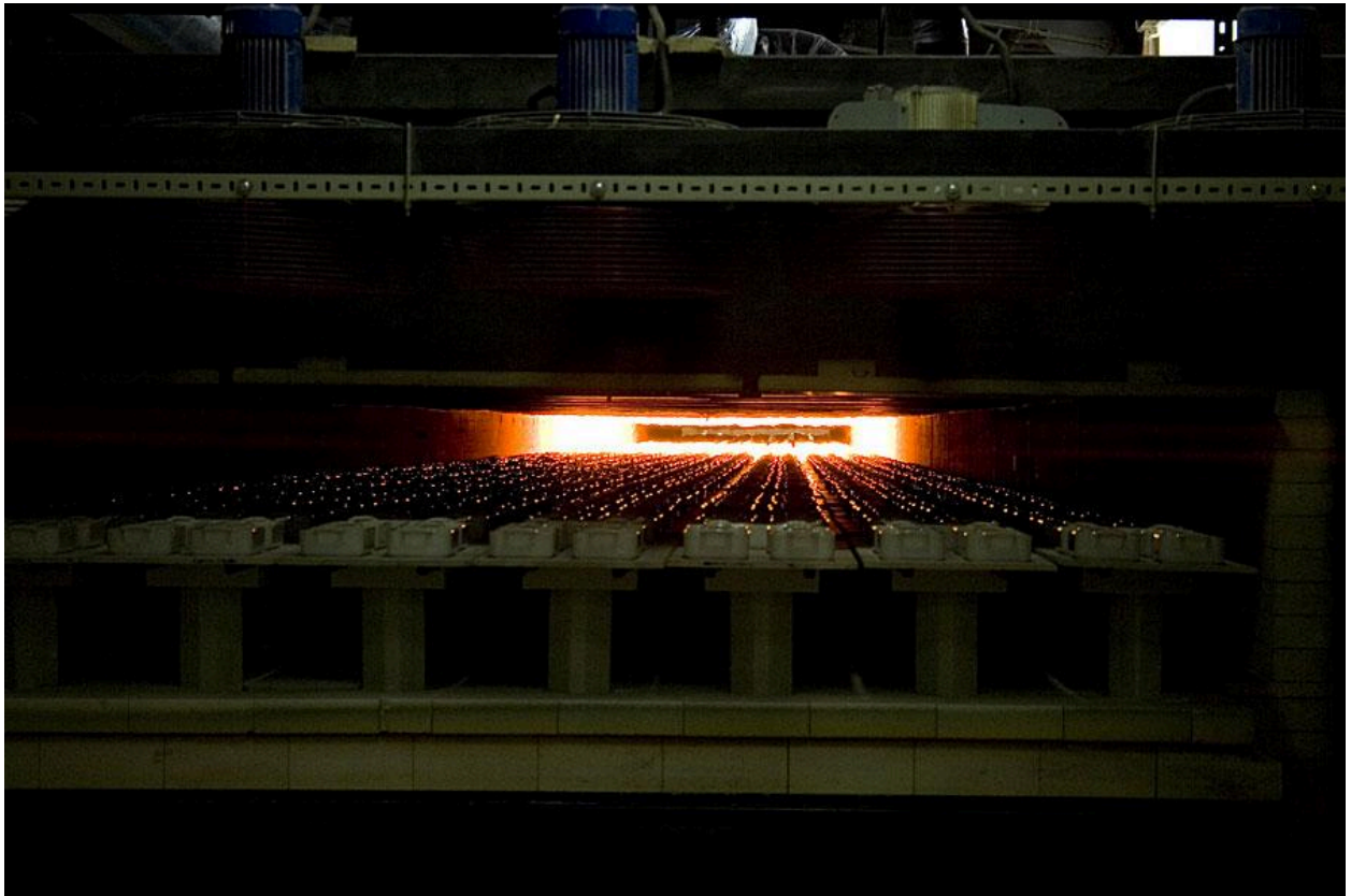
Détail four tunnel
