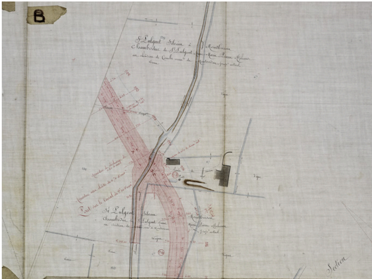
[Plan-masse du cuvage de la Cave en 1887 ; en rose, le tracé du futur canal du Forez].
