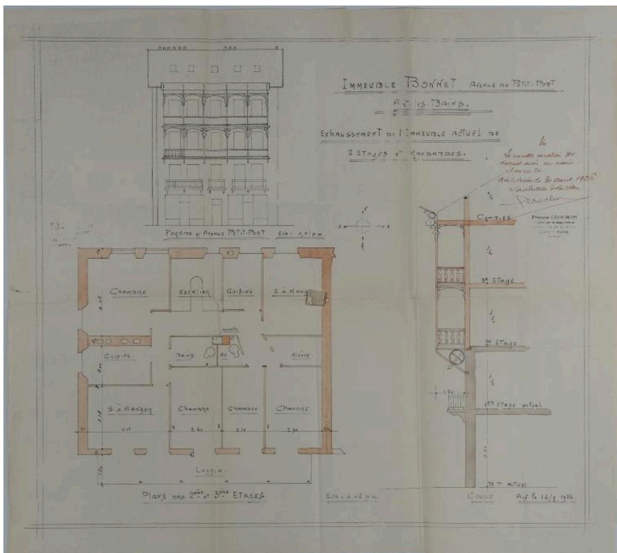
Exhaussement de 1926: plan, coupe et élévation.
