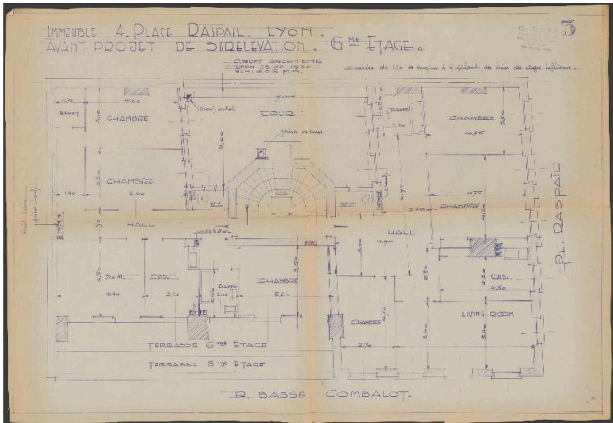
Avant-projet de surélévation. Plan du 6e étage / C. Ruff architecte. 1950 (AC Lyon, 345 W 4)
