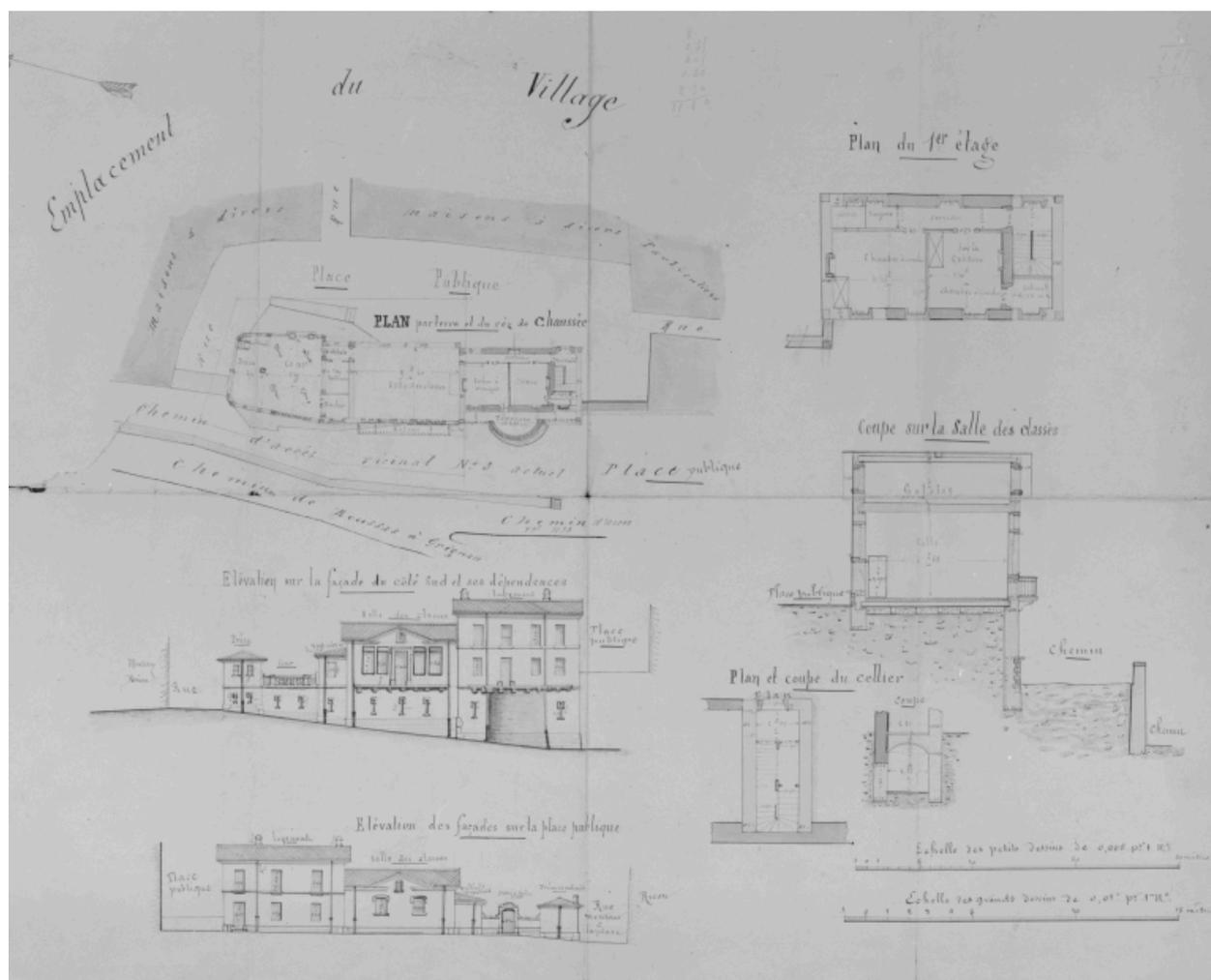
[Commune de Valaurie...] Plan par terre et du rez-de-chaussée - Plan du 1er étage - Coupes sur la salle des classes - Plan et coupe du cellier - Elévation sur la façade du côté sud et ses dépendances - Elévation des façades sur la place publique (3e projet pour l'école des filles).
