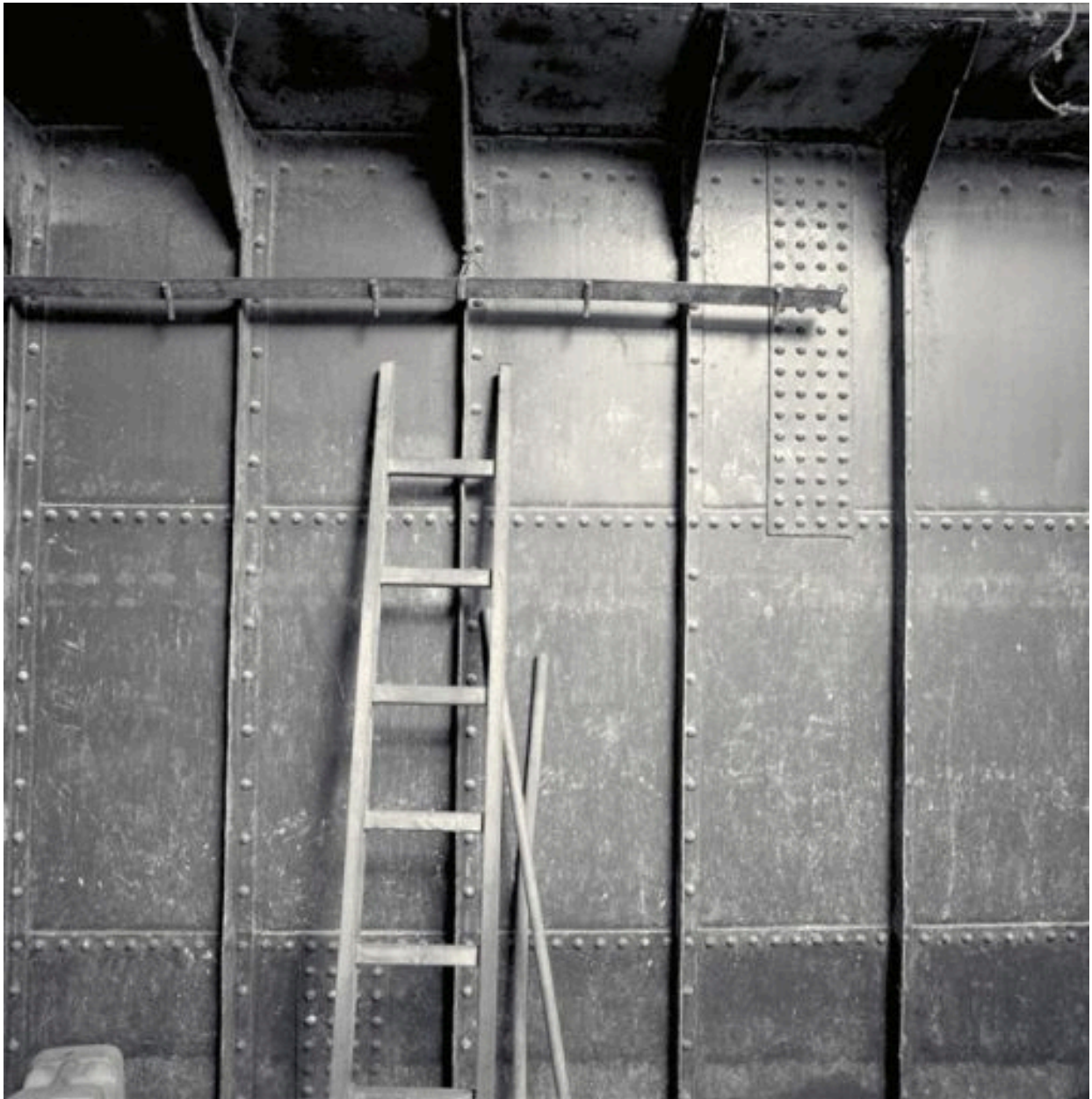
Détail de l'assemblage des parois de la cale
