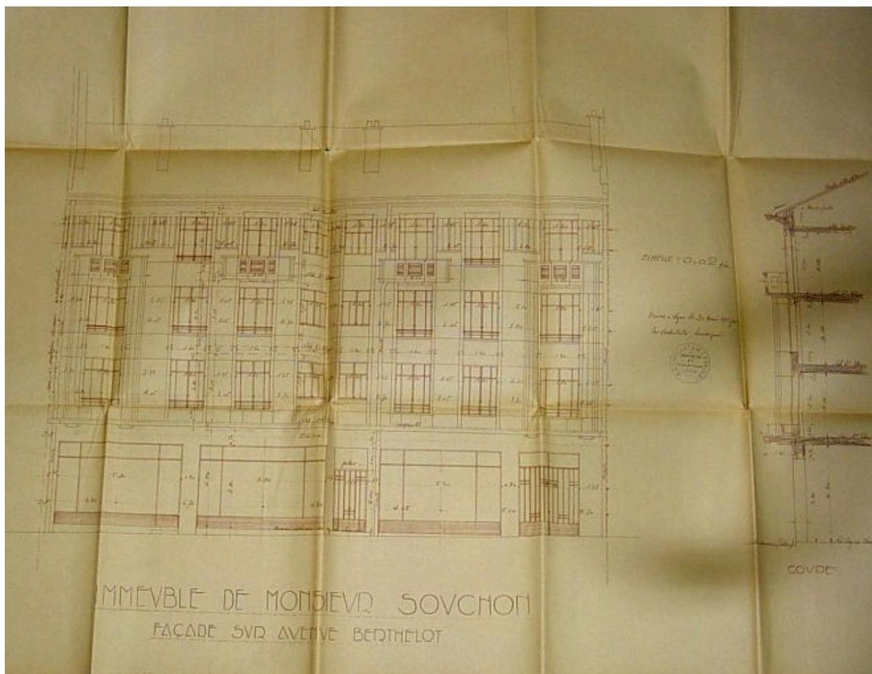
Élévation sur rue avant exhaussement
