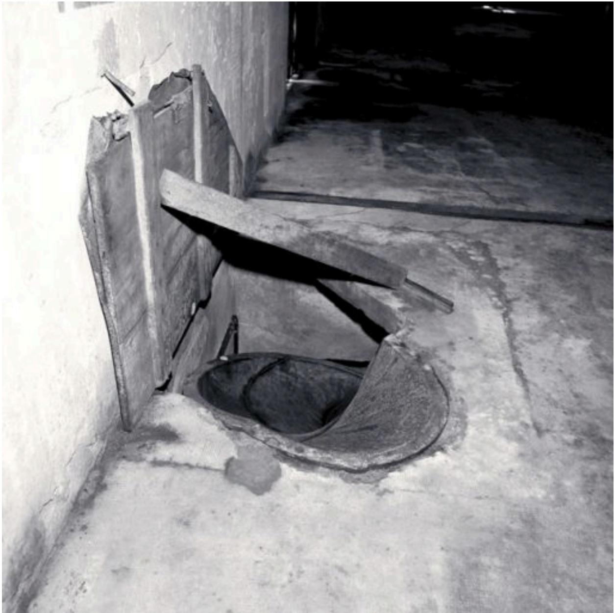
Intérieur du bâtiment de 1927 (bâtiment sud) : manutention du sucre en sac, départ d'un tourniquet
